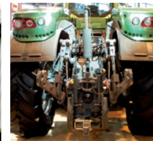
▲ In de spatborden zitten knoppen voor de bediening van de aftakas, trekstangen en de hydraulische topstang. Tevens zitten er camera's voor zicht op de hef (rechter spatbord) en het werk (linker spatbord).
