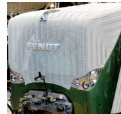
▲ Voorop zit er bovenop de neus een camera zodat je kunt zien wat in de fronthead gebeurt.
