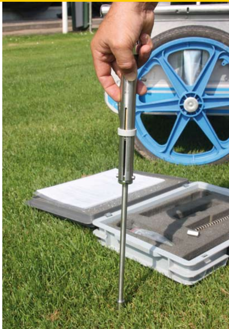
Penetrometer voor de toplaag van een bodem
