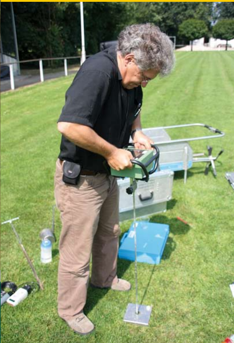
Penetrometer voor diepere metingen
