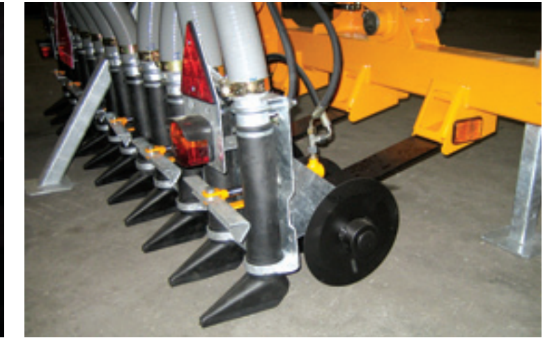
De Ecoject bemester is uitgerust met bladveren. De dubbelwerkende, hydraulisch bediende voetafsluiter zorgt voor een snelle afsluiting. Tijdens ruststand kan de sluiting open blijven staan.
