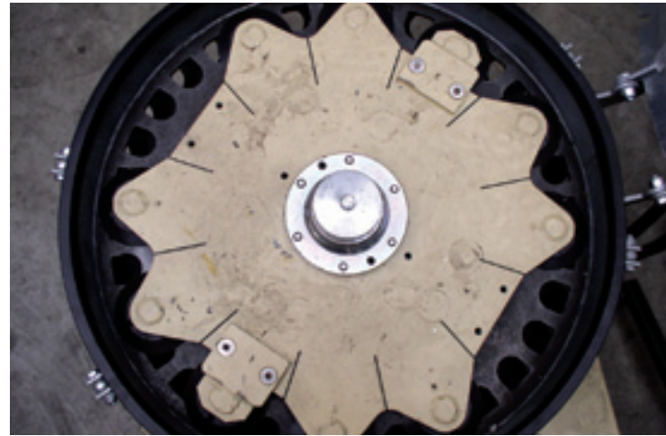
De mest doorstroomgaten in de snijverdeler zijn boogvormig voor een betere snijding. Extra messen kunnen worden gemonteerd voor een grotere overdruk.
