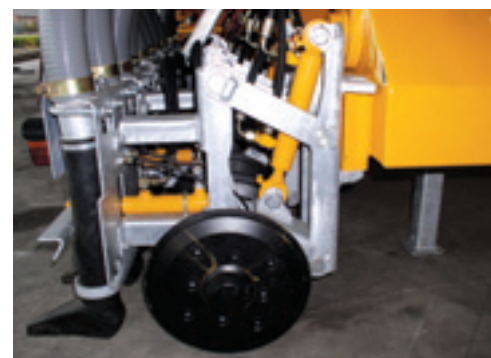
De hydraulisch bediende schijfkouters op de Euroject zorgen voor een even diepe insnijding in de grond over de gehele werkbreedte.
