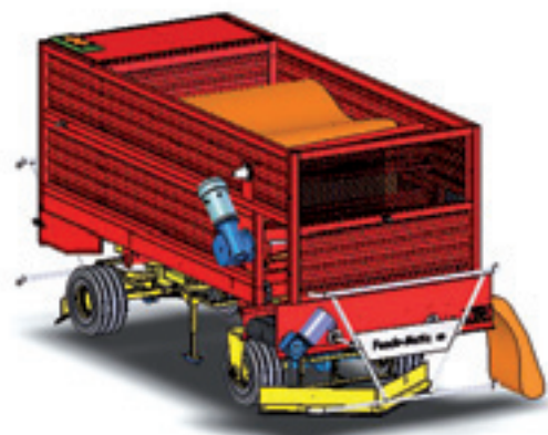
De robot van Schuitemaker lijkt sterk op de Feedo doseerwagen met aan de voorzijde een schuif en een losband.
