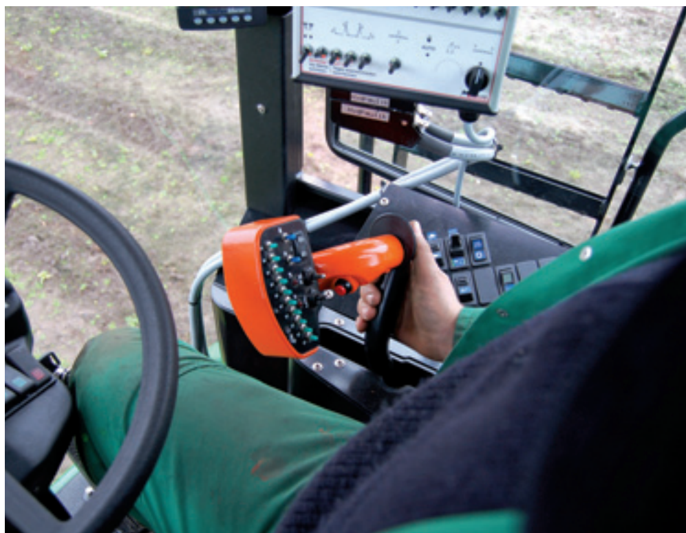
De rijhendel voor de hydrostaat bevat ook de sectiebediening van de spuitboom.
