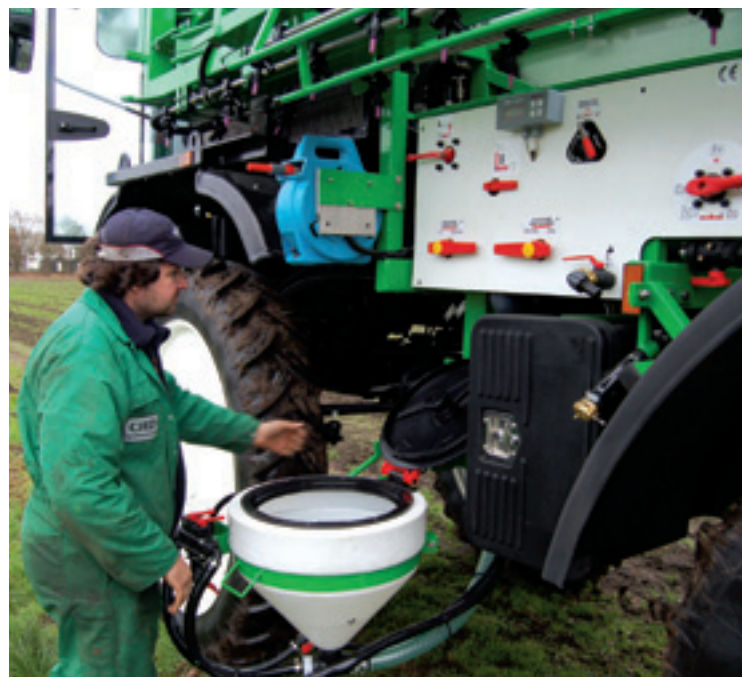
Bedieningspaneel is van een bestaande getrokken spuit genomen.
