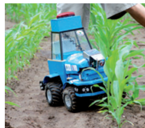
▲ Cornickel van de Duitse universiteit uit Dresden viel op door zijn uiterlijk. De 8 kg zware als op een trekker uitzijnde machine presteerde niet goed. Er moest te vaak worden ingegrepen.
