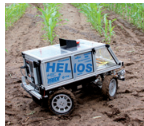
▲ Winnaar Helios weegt 20 kg en keert met vierwielbesturing. Het navigeren gaat via twee infraroodsensors, drie ultrasoonsensors, temperatuursensors en een kompas.
