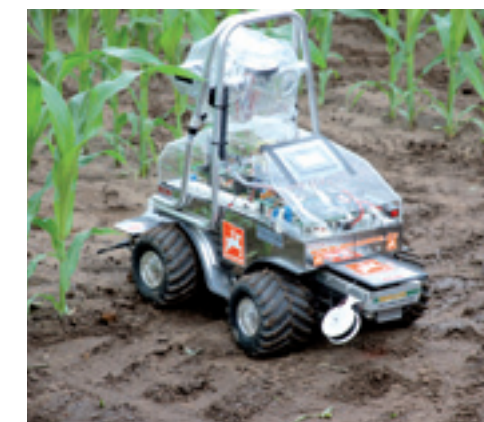
▲ Amaizeing was de snelste. Dit robotje weegt 10 kg en heeft brede lagedrukbanden. Amaizeing slaat op de vele sensors: 17 in totaal. Totale bouwkosten zijn 1.809 euro.
