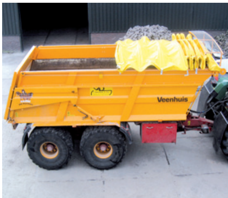
▲ Het Cabriolé-zeil dekt in gesloten toestand het product af. Wanneer het zeil opgevouwen is, zie je duidelijk de staalkabels en de poelies aan de bakrand. In het zeil zitten stalen bogen zodat je de kipper goed vol kunt laden.
