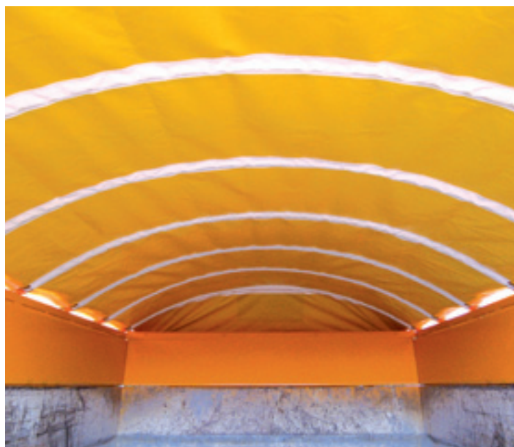
▲ Het Cabriolé-zeil dekt in gesloten toestand het product af. Wanneer het zeil opgevouwen is, zie je duidelijk de staalkabels en de poelies aan de bakrand. In het zeil zitten stalen bogen zodat je de kipper goed vol kunt laden.
