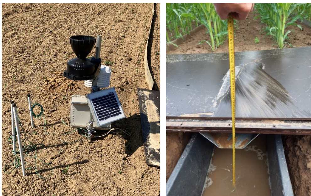
Afbeelding 4 Weerstation WolkyTolky en meting afspoeling in opvangbak
