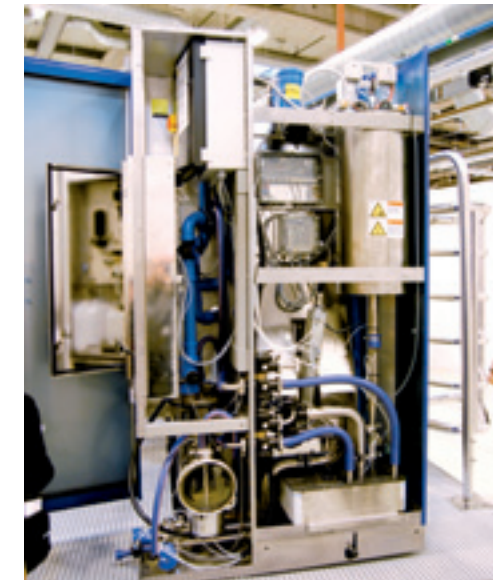
In het grote roestvaststalen vat rechts van de melkunit wordt vast 30 liter warm water klaar gezet. Zo haalt de robot haar hogere capaciteit.
