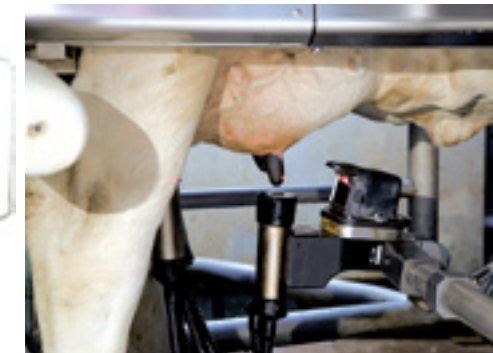
Vanaf eind 2007 zal de DeLaval arm de bekpers met magneten vastpakken in plaats van een grijpertje.
