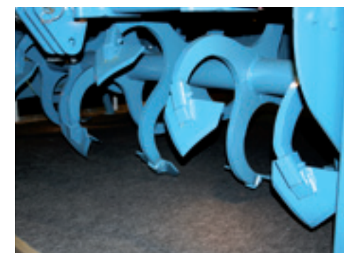
▲ Met de SX-spade van Imants kun je eenvoudig spaden wisselen zonder het gebruik van slijptol en lasapparaat.
