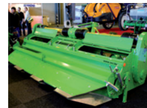
▲ Een tandwielaandrijving aan de zijkant van de rijenfrees zorgt ervoor dat je ook met trekkers met een groot aftakasvermogen kunt rijden. Een dubbele aandrijving is optioneel.
