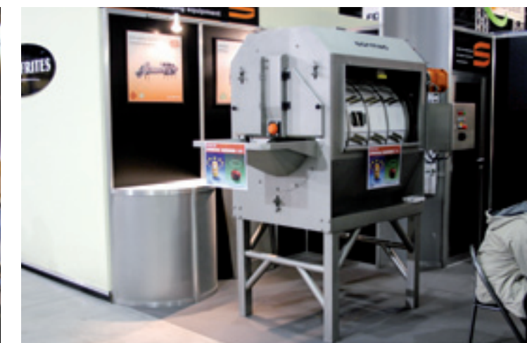
▲ De Sormac MS-mini heeft een lagere capaciteit dan de MS-1T. In plaats van 1.000 kg kun je hiermee 500 kg per uur verwerken.
