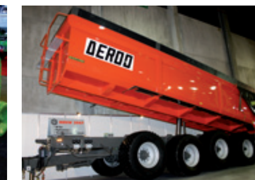
▲ Deroo bouwde een vierassige kipwagen met een maximum laadvermogen van ruim 28 ton.
