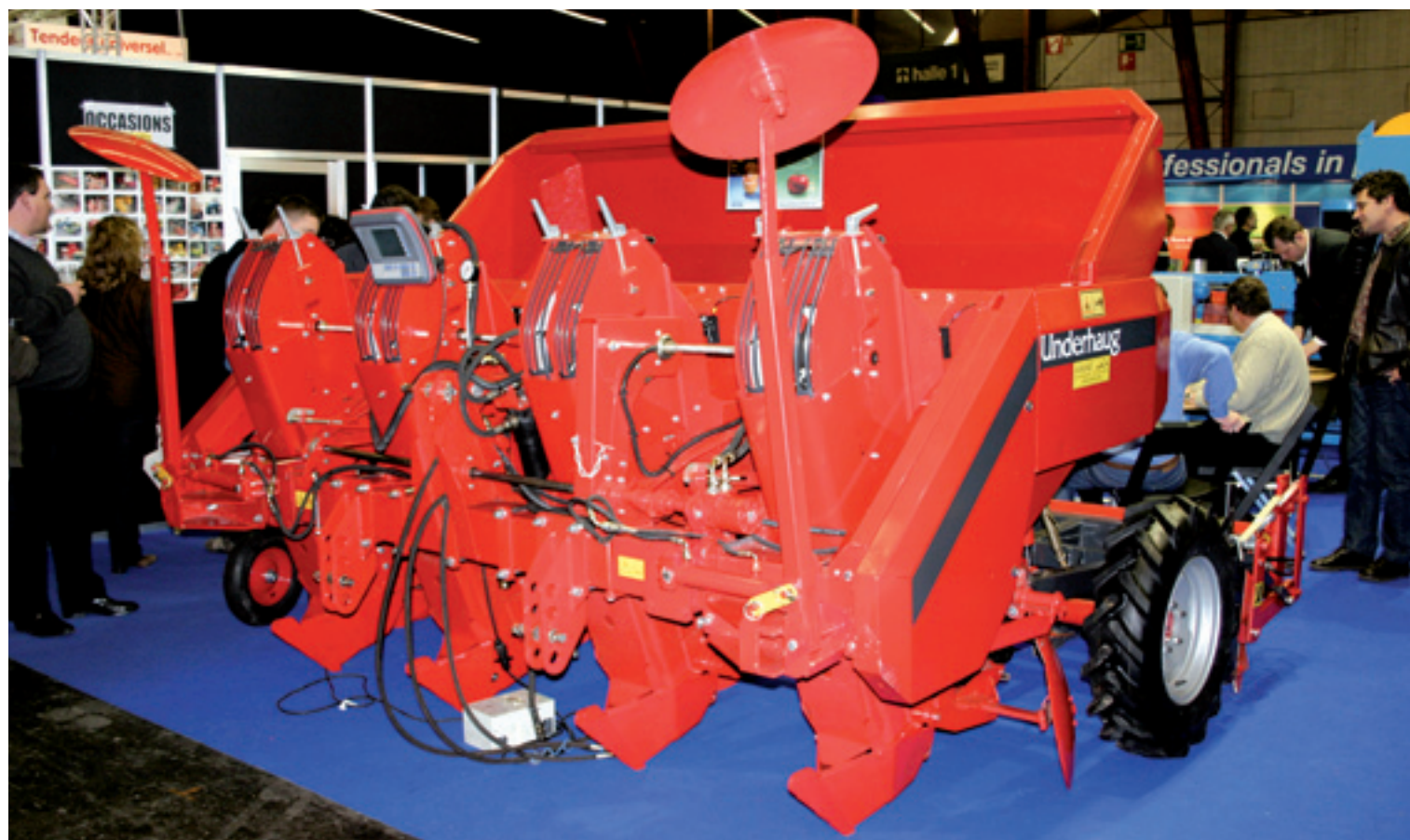
▲ De UP 3741 is hydraulisch aangedreven en heeft een computer aan boord om de belangrijkste instellingen te kunnen wijzigen.
