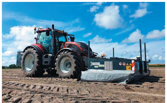
De Zasso XPower is een van de beschikbare machines voor elektro fysische bestrijding van knolcyperus.
