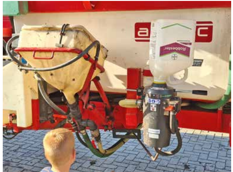
Afgelopen jaren hebben diverse loonwerkers en akkerbouwers de Pentair Clean Load Nexus getest. Het systeem werkt snel en veilig, maar kleine hoeveelheden doseren is lastig.
