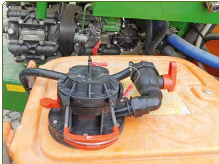
De Agrotop easyFlow-tankconnector kost slechts € 200,-. Nauwkeurig doseren kan hiermee echter niet.
