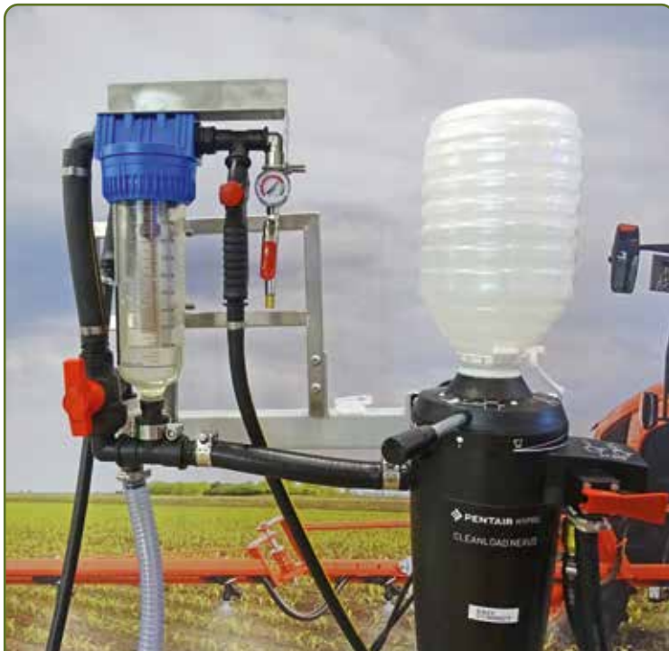
De Pentair Clean Load Nexus is robuust, maar de maatglas-oplossing oogt wat provisorisch.
