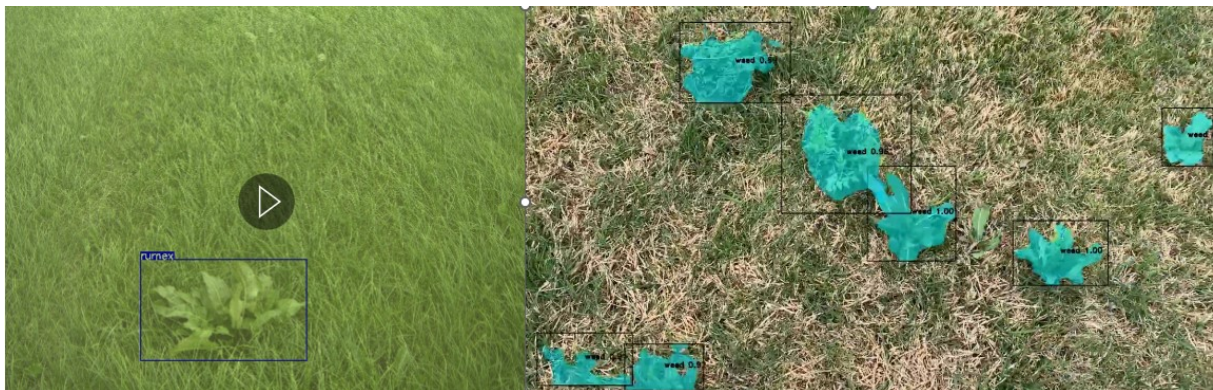
Afbeelding 3 Links: Detectie van Rumex met YOLOv3 in grasland Rechts: onkruiddetectie met Mask R-CNN in grasland. Uit: [13].
