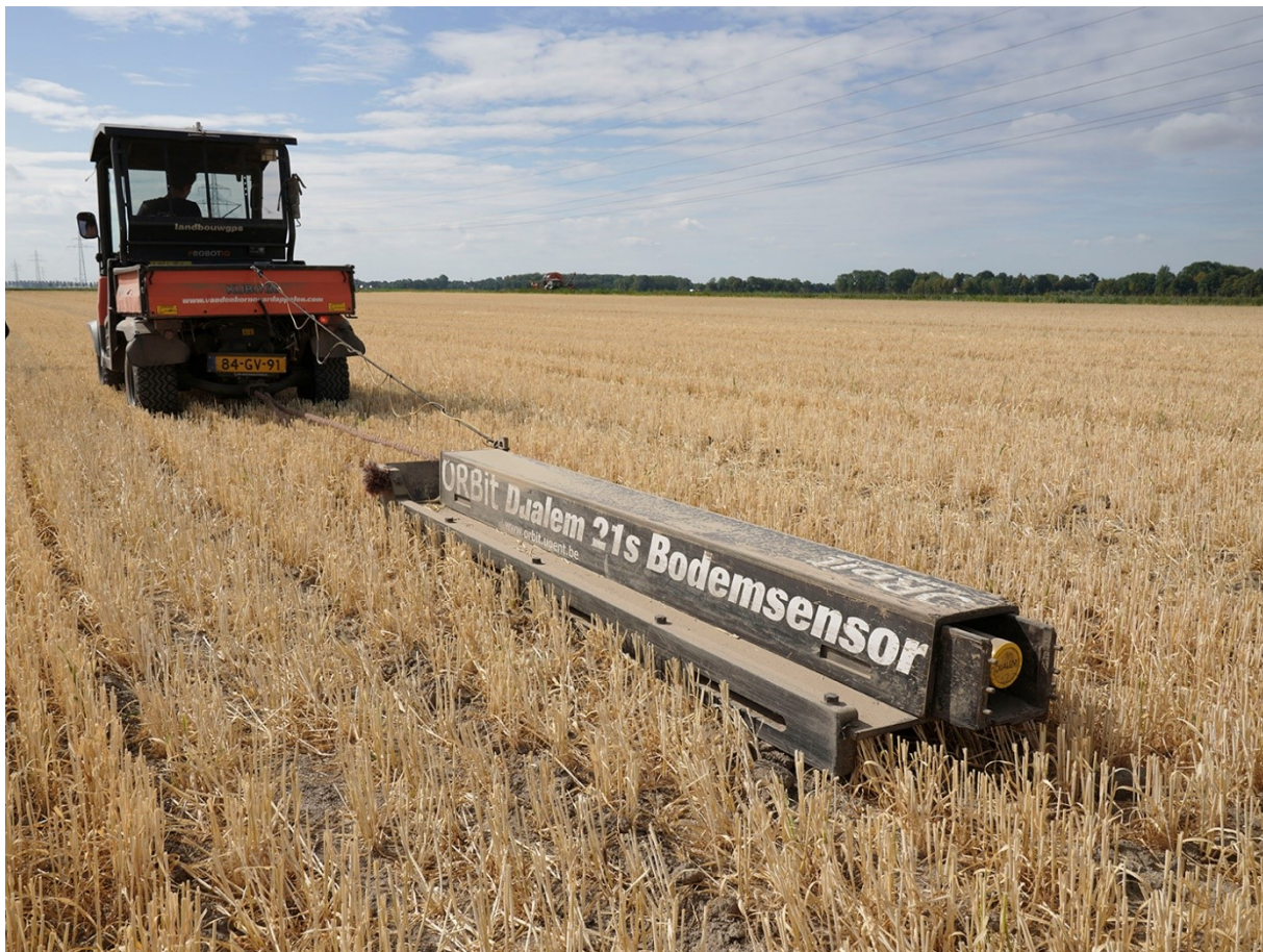
Afbeelding 2 Een voorbeeld van hoe een bodemscanner kan worden gebruikt in grasland. Hier te zien is de Dualem 21S bodemscanner. Van [1]
