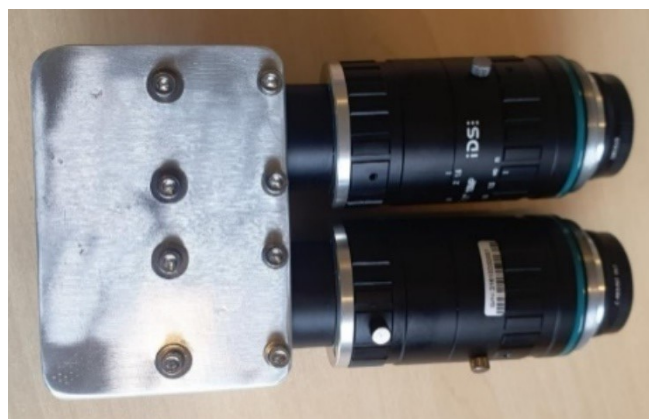
Afbeelding 4 Voorbeeld van een relatief betaalbare multispectrale camera. Deze 'stereo set-up' maakt gebruik van twee camera's en twee lenzen, beiden met een filter die een specifieke bandbreedte licht doorlaat.
