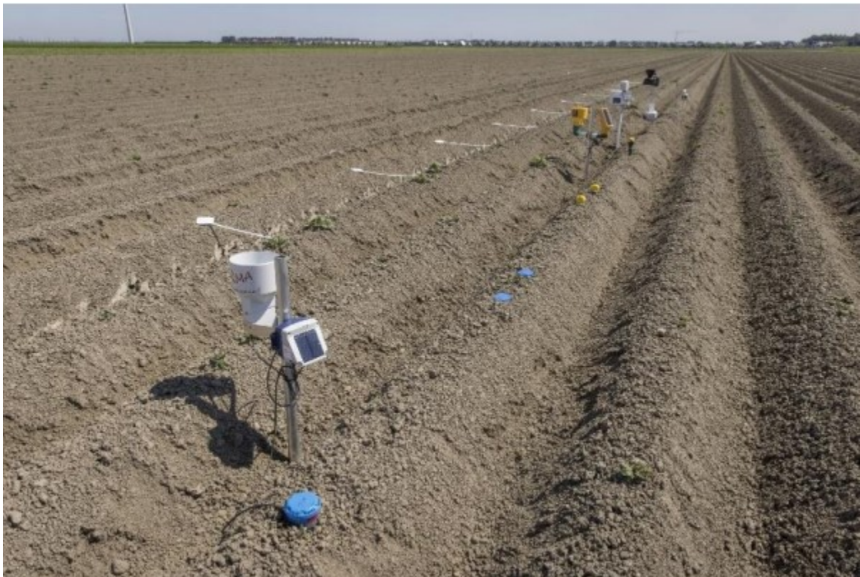
Afbeelding 1 Een voorbeeld van de verschillende soorten bodemvochtmeters zoals ze worden gebruikt in de landbouw. Uit: [2].
