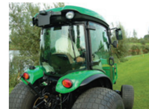
Voor van achteren zie je goed de ronde vorm van het glas. Midden aan de dakrand zit nog een extra werkklamp die op de hef is gericht.
