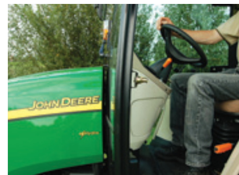
De cabine is een aparte constructie en is via vier rubbers op het chassis gemonteerd. Motorkap en cabine zijn dus los van elkaar, je kunt er tussendoor kijken.
