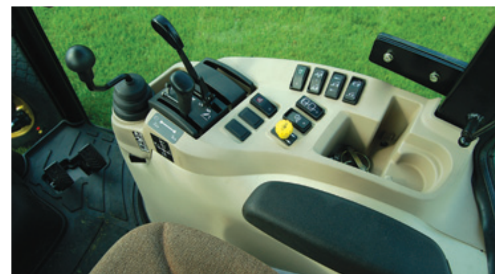
Rechterconsole met links bediening van voorlader joystick, hydraulische topstand en hef. Rechtsboven schakelaars zwaailicht, cruise control (aan-uit-SpeedMatch), cruise control bijregelen en MotionMatch. Daaronder de schakelaars voor ruitenwissers en werkklampen, en de gele aftakasknop.
