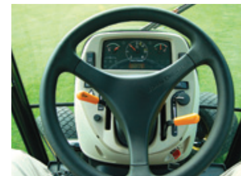
Het vernieuwde dashboard met rechts de gashendel en links een hendel voor vierwielaandrijving. Linksboven zit de LoadMatch schakelaar.
