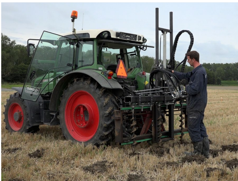
Figuur 2: Gatendoor voor grote gaten ('mechanische mol', 10cm diameter)
