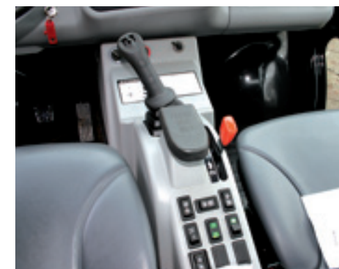
De joystick voor de aansturing van de voorlader is in de middenconsole geplaatst. Met drukknoppen schakel je het differentieelslot en de vierwielbesturing in.
