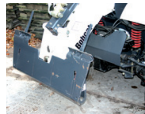
De aankoppelbok van de voorlader is dezelfde als die van de grotere wiel-laders van Bobcat. Zo kun je werktuigen uitwisselen tussen de twee typen machines.
