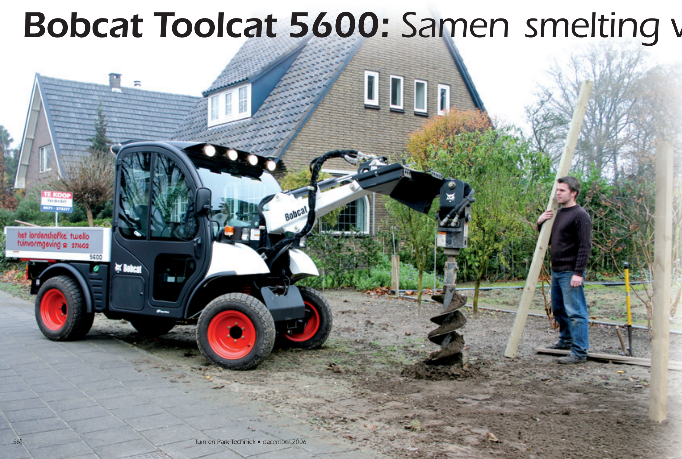
De motor is achter de cabine en onder de kiepbak geplaatst. De ruime bouw zorgt ervoor dat je alles goed kunt bereiken.
