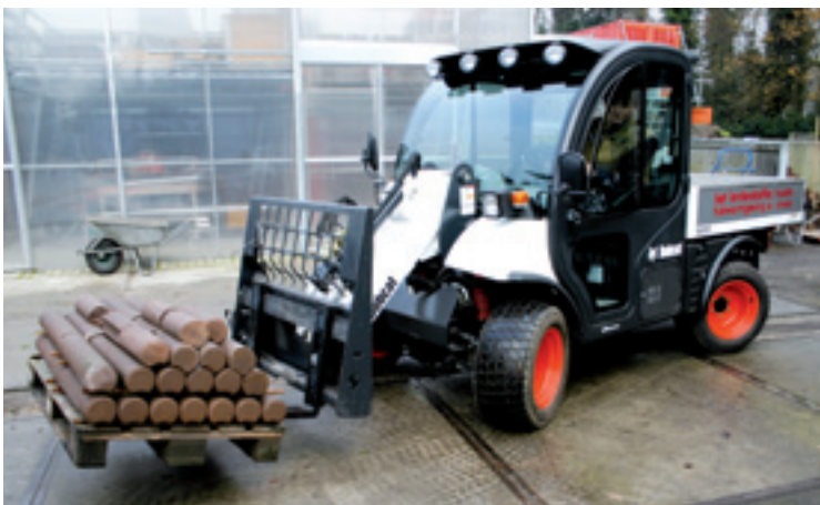
Henk Mulder heeft de vierwielbesturing ingeschakeld. Dit werkt volgens hem erg makkelijk bij korte bochtjes en lastig bereikbare plaatsen.
