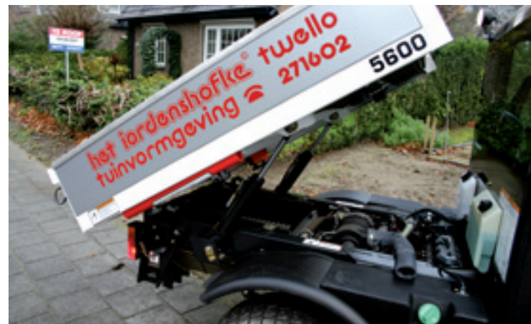
De achterbak kun je kiepen. Hier zorgen twee enkelwerkende cilinders voor.
