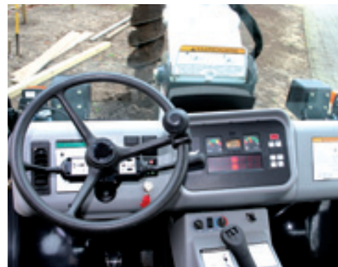
Alle belangrijke functies zitten binnen handbereik. De vooruit-achteruit-schakeling zit links naast het stuur.
