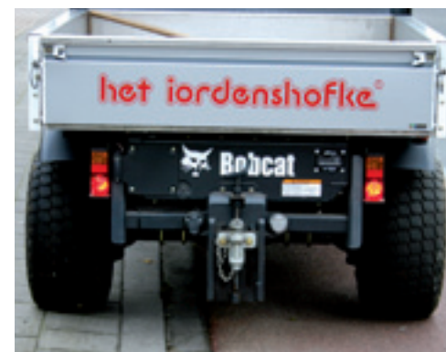
De achtertrekhaak is met een draadspindel in hoogte regelbaar. Handig voor verschillende typen aanhangers.
