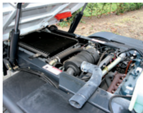
De motor is achter de cabine en onder de kiepbak geplaatst. De ruime bouw zorgt ervoor dat je alles goed kunt bereiken.
