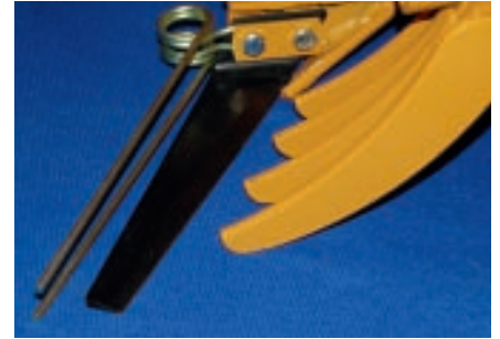
(Figuur 3) Een veertand boven het kopmes voorkomt dat bladpruikken met de bieten meegaan en meetellen als tarra.
