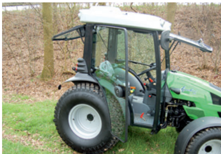
De cabine heeft grote deuren om makkelijk in te stappen. Airco en werkklampen zijn mooi geïntegreerd.
