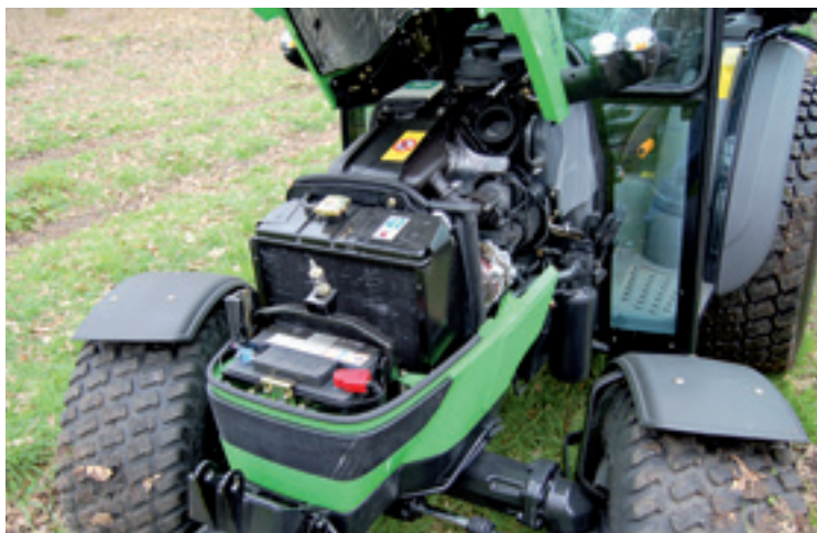
Onder de in één deel te openen kap schuilt een motor van Mitsubishi.
