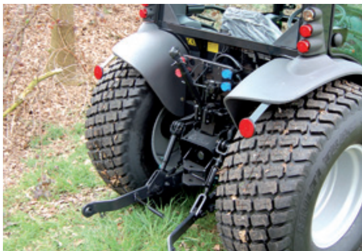
Achter zijn de aansluitingen voor twee dubbel werkende ventielen te vinden en een hef die 1.200 kg tilt.
