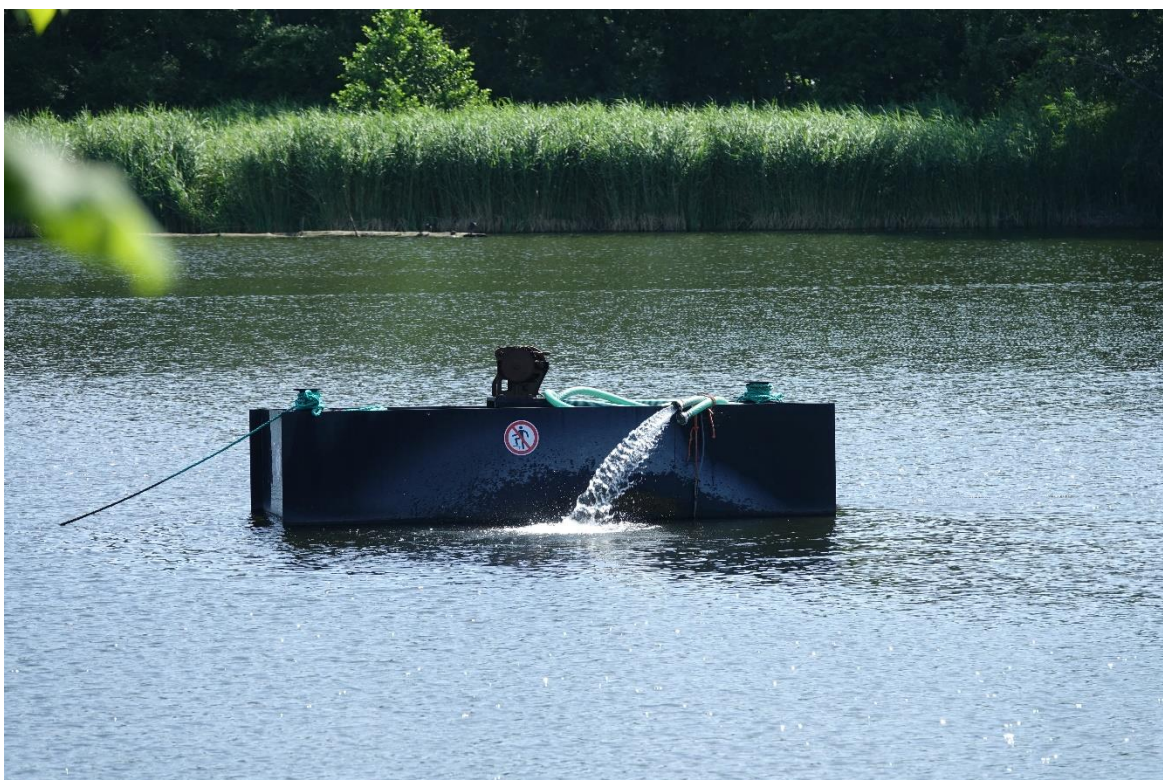
Afbeelding 3. Drijver met daaronder een big bag met ijzerzand en pomp. Het gefilterde water wordt op het wateroppervlak geloosd (foto: Arjen Koomen)
