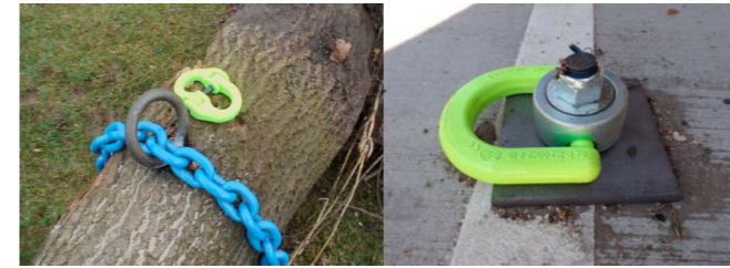
Stalen ketting door oog in de boom (links) en hijs oog aan betonplaat als ballast (rechts) [19].
