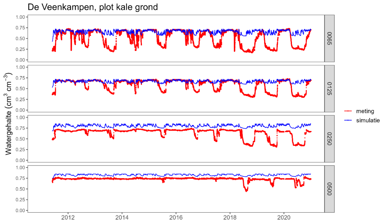
Figuur 3.16 Gemeten (rood) en gesimuleerde (blauw) watergehaltes in de bodem op vier dieptes (6.5, 12.5, 25, 50 cm -mv) voor de onbegroeide plot (kaal) op locatie De Veenkampen.
