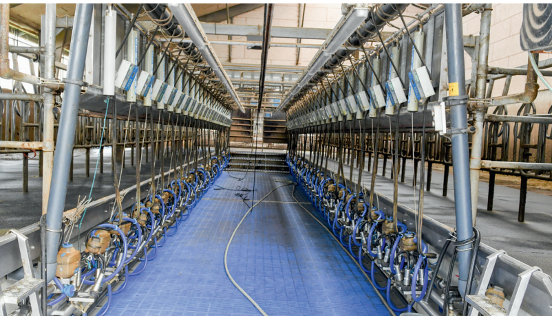
De koeien worden twee keer daags gemolken in een 2x24 stands zij-aan-zijmelkstal met snelwisselsysteem
