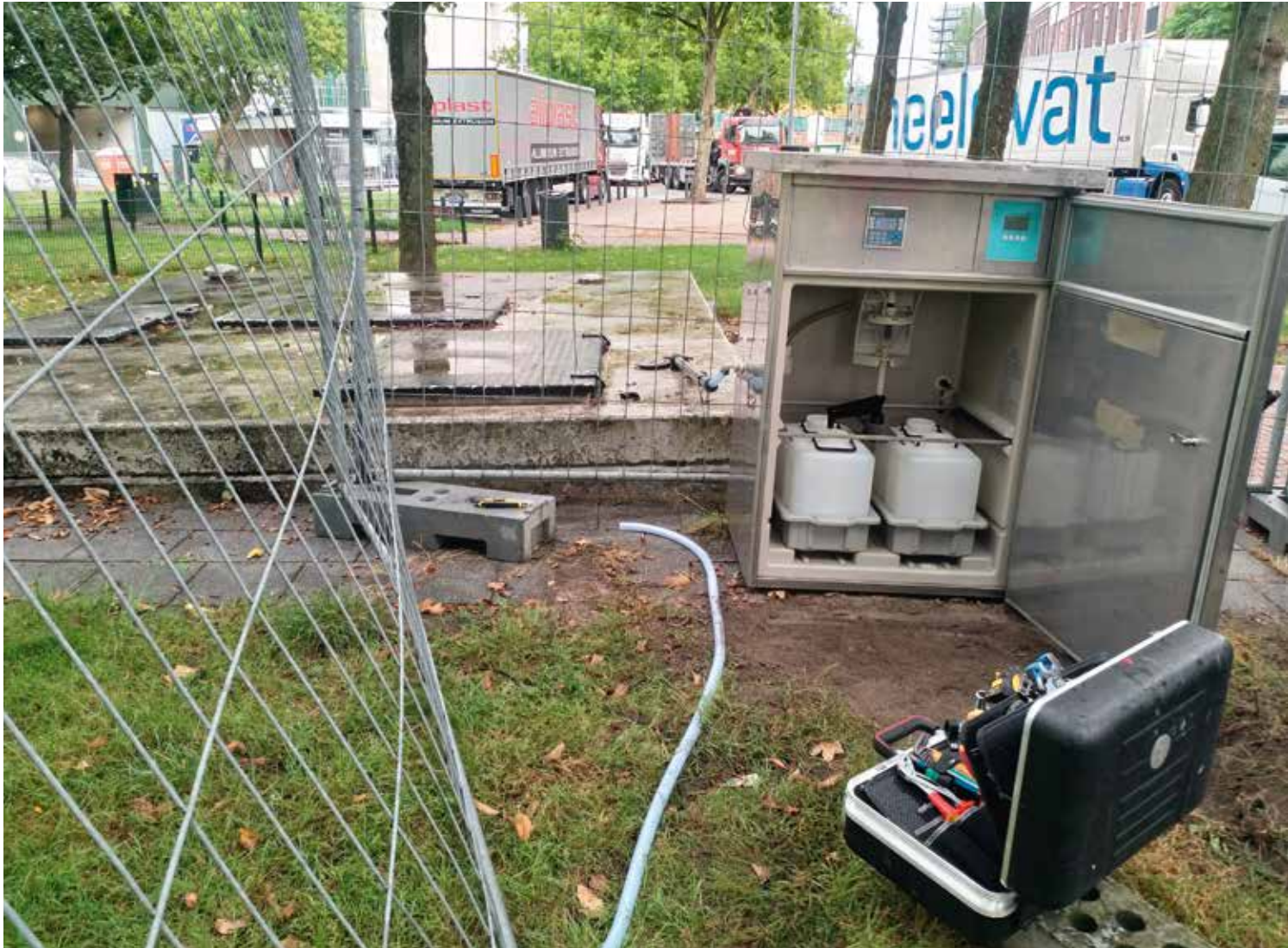
Monsternamekast bij het ondergrondse rioolgemeal Katendrecht. De apparatuur voegt op gezette tijden een beetje rioolwater toe aan een monsternamevat, om een representatief 24-uurs monster te krijgen.
