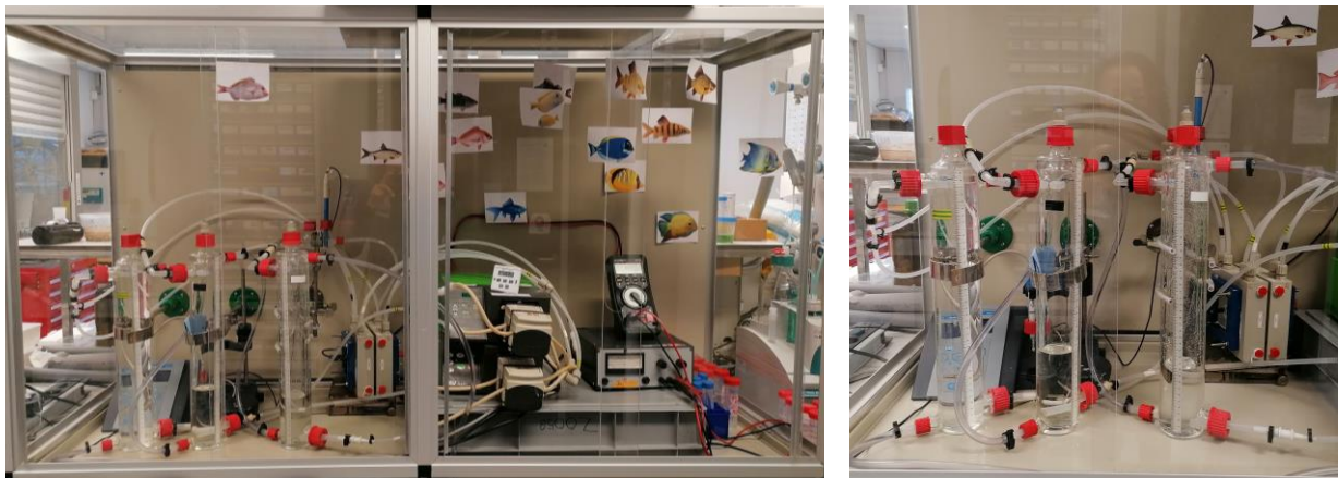
Figuur 4-3 Opstelling gebruikt voor ED en EDBM (links) en in meer detail (rechts) de elektrolyse unit en in- en uitgaande vloeistoffen.
