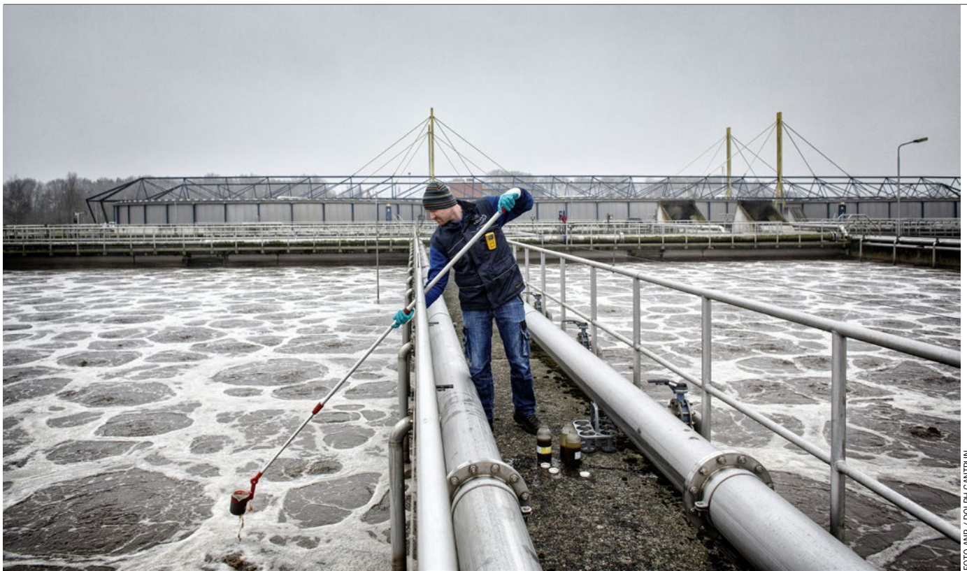
Monsters van afvalwater bij de rioolwaterzuivering in Tilburg worden onderzocht op de hoeveelheid fosfaat, nitraat, ammonium en droge stof.
