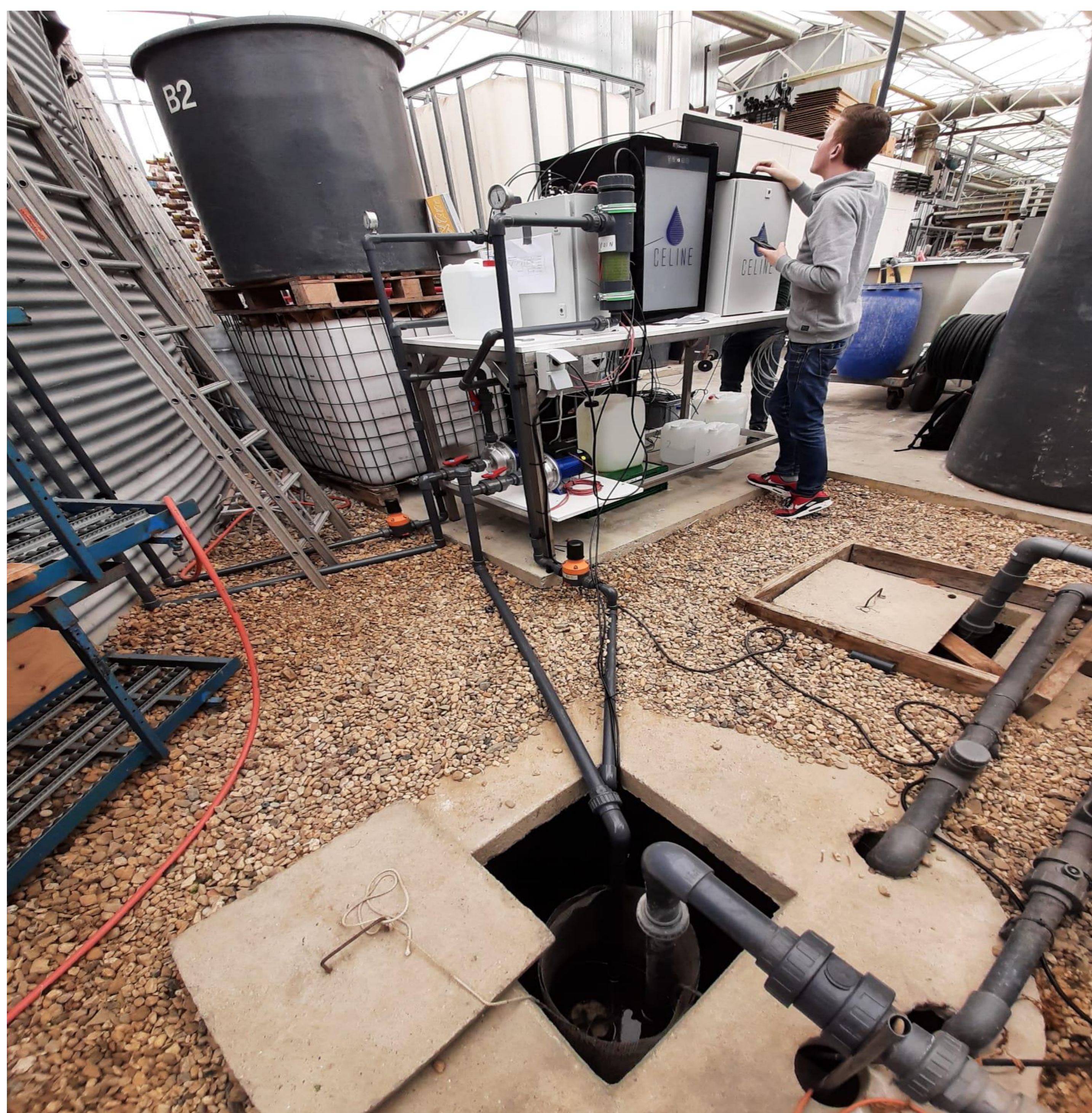
Figuur 1. De Celine-apparatuur. Het meet de afvoer van de put (hieronder op de foto) en de gift van de dagelijkse voorraadsilo (links in de foto).
