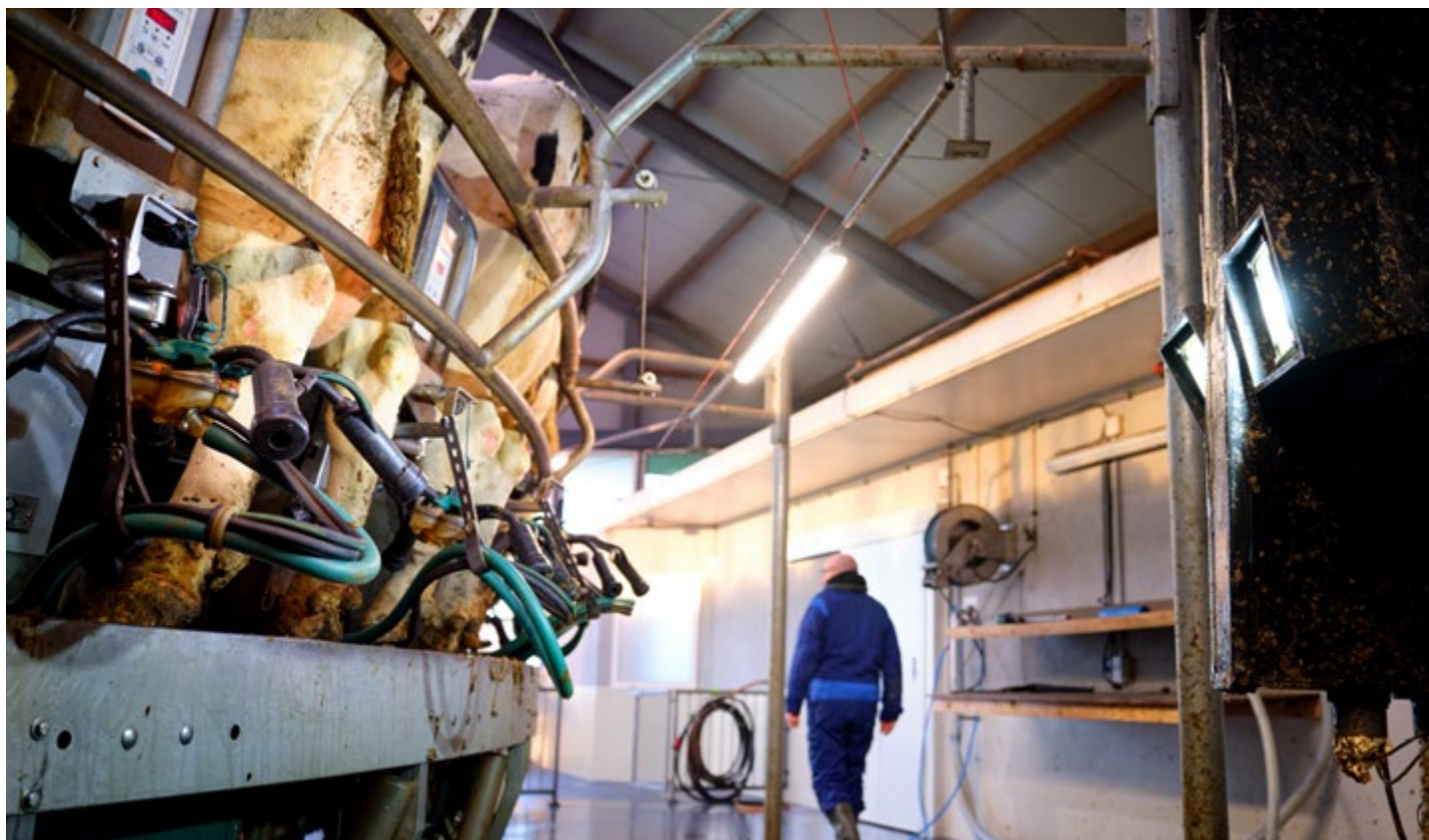
In de melkcarrousel worden de hoeven van koeien automatisch gefotografeerd. Onderzoekers bekijken in hoeverre sensortechnologie kan helpen bij vroege detectie van Mortellaro, een bacteriële pootinfectie. ♦ Foto Jeroen Bouman
