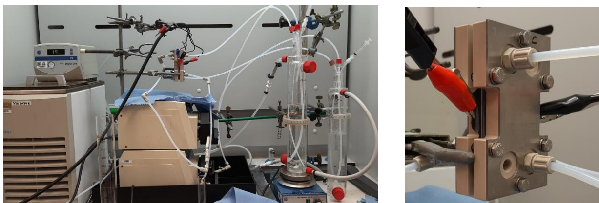
Figuur 6 Foto van de gebruikte flow opstelling (links) en de elektrochemische flow-reactor (rechts)
