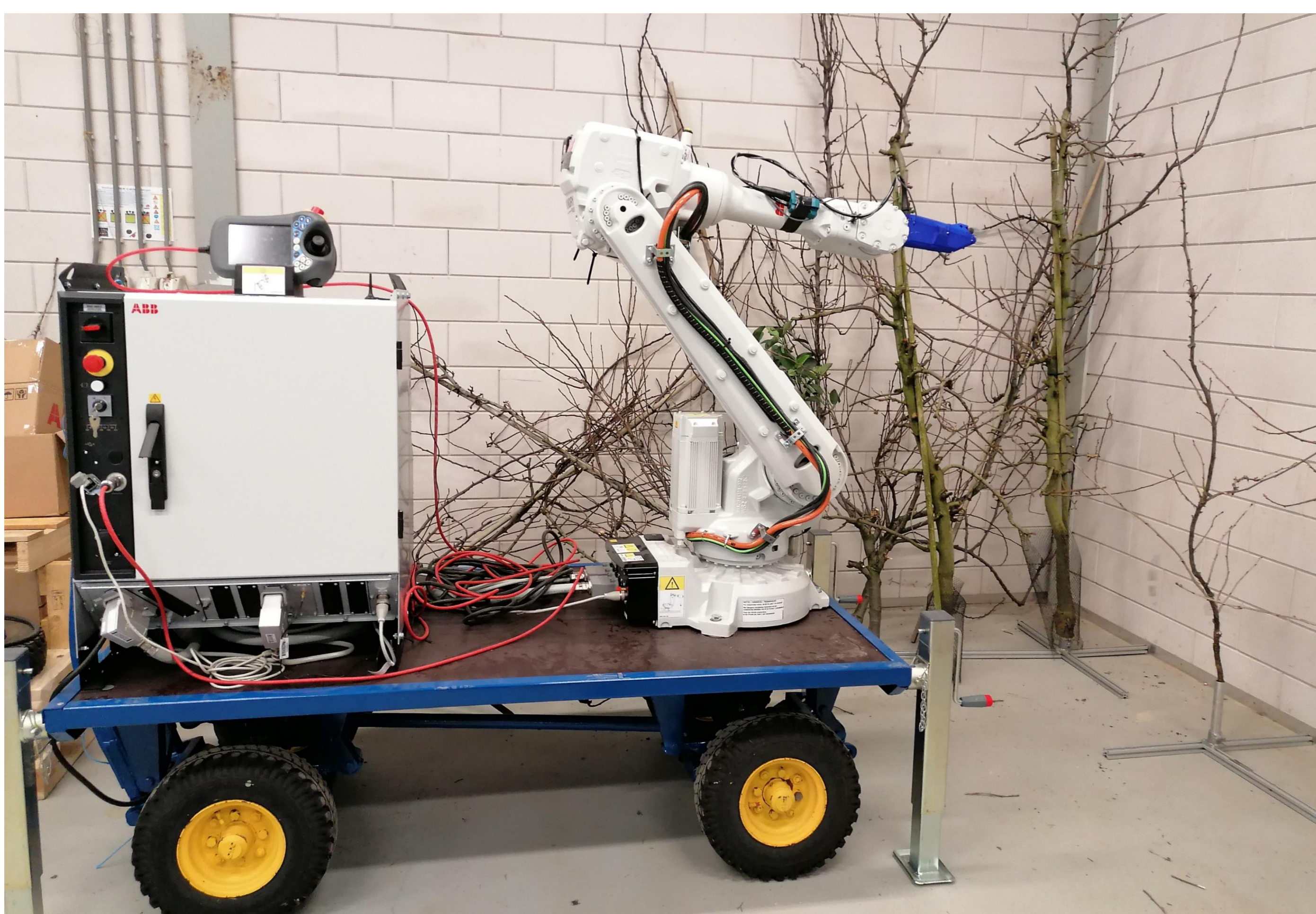
Proefopstelling met robot arm op een mobiele kar
