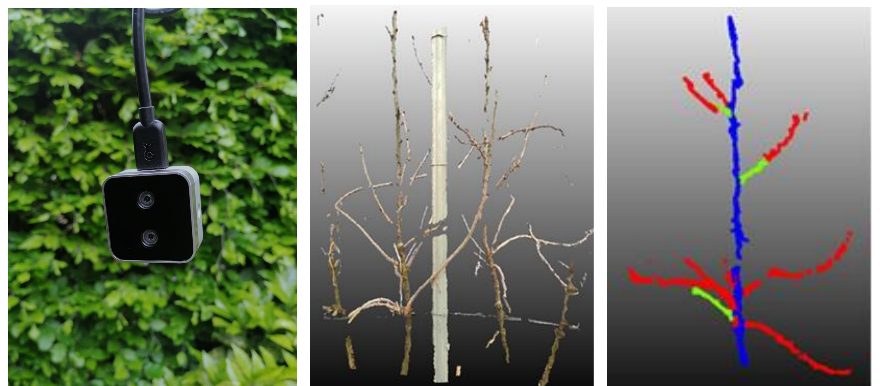
Potentieel 3D camera systeem: RealSense D405 (links), puntenwolk van rode bessen (midden), geclassificeerde puntenwolk: hoofdstam [blauw], 2-jarig hout [groen], 1-jarig hout [rood] (rechts)
