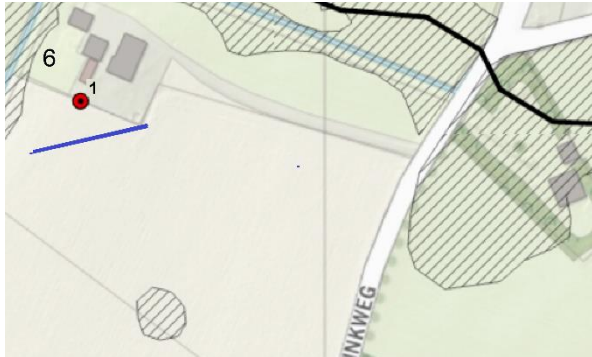
Figuur 4.23 Plattegrond proeflocatie met één peilbuis nabij de uitvloeibuis (blauwe lijn).
