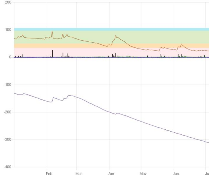
Figuur 11 Gemoduleerde en gemeten grondwaterstanden van behandeling bevloeiing en de referentie (paarse lijn onder de x-as) voor perceel 2. De vochttoestand in de bodem is aangegeven met een bruine lijn, waarbij in de blauwe zone sprake is van vernatting, in de groene zone de vochtvoorziening optimaal is, in de oranje zone vocht limiterend wordt en in de licht rode zone sprake is van vochttekort (droogte). De kruisjes in de grafiek van bevloeiing geven de gemeten grondwaterstanden weer.
