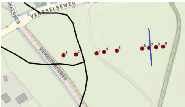
Figuur 4.15 Plattegrond proeflocatie met peilbuis 1-9 op een lengteraaï en ter hoogte van peilbuis 7 de uitvloeibuis (blauwe lijn).
