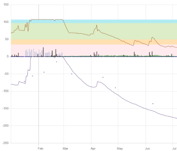
Figuur 14 Gemoduleerde en gemeten grondwaterstanden van behandeling bevloeiing en de referentie (paarse lijn onder de x-as) voor perceel 5. De vochttoestand in de bodem is aangegeven met een bruine lijn, waarbij in de blauwe zone sprake is van vernatting, in de groene zone de vochtvoorziening optimaal is, in de oranje zone vocht limiterend wordt en in de licht rode zone sprake is van vochttekort (droogte). De kruisjes in de grafiek van bevloeiing geven de gemeten grondwaterstanden weer.
