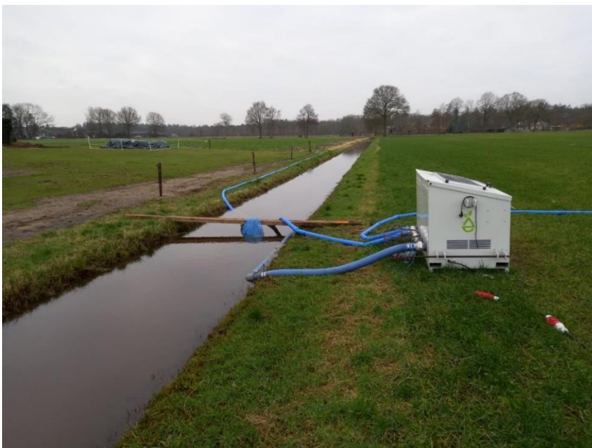
Figuur 3.3 Dieselgenerator met druppelirrigatie pomp en een aanzuig slang in een watervoerende sloot.
