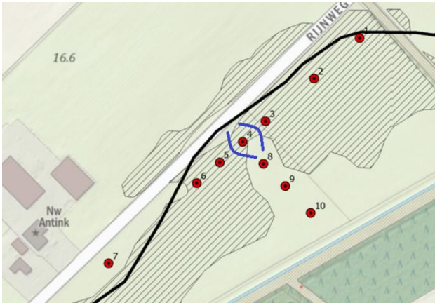
Figuur 4.11 Plattegrond proefperceel met peilbuis 1-7 op een lengteraaai en peilbuis 8-10 op een breedteraaai ter hoogte van twee uitvloeingsbuizen (blauwe lijnen).
