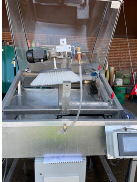
i. Deze procedure van opbrengen reinigingsmiddel, laten inwerken, borstel reinigen wordt tevens 10 keer herhaald om de levensduur van een kas van ca. 10 jaar, uitgaande van minimaal 1 keer per jaar reinigen, na te botten.
