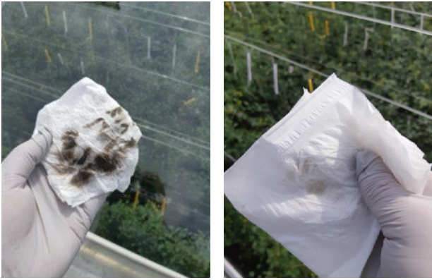
Figuur 37 Afname vuil met filters op vuile en schone glazen uit de praktijk.
