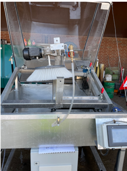
b. De borstel beweegt automatisch met een draaiende beweging over het glas heen en weer met een toerental van 200 rpm en een rijsnelheid van 250 mm/s.
