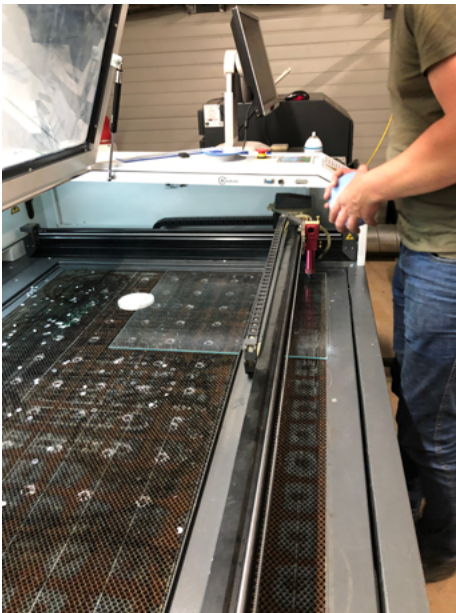
c. Lasercodering van alle glasplaten, elke plaat krijgt een unieke code die ook na het reinigen nog leesbaar is om de behandelingen en resultaten de traceren
