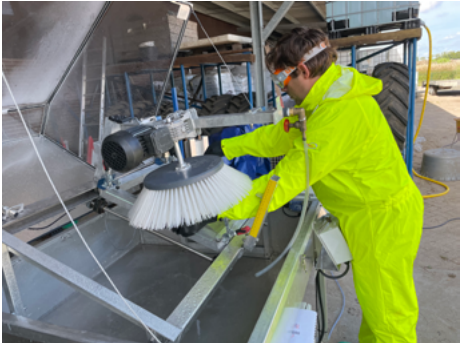
h. Glas 2 reinigen met borstelmachine (hier: komborstel), opstelling geleverd door Besseling.
