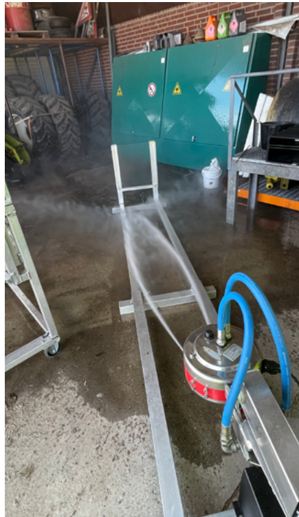
g. Deze procedure van opbrengen reinigingsmiddel, laten inwerken, hogedruk reinigen wordt tevens 10 keer herhaald om de levensduur van een kas van ca. 10 jaar, uitgaande van minimaal 1 keer per jaar reinigen, na te botten.
