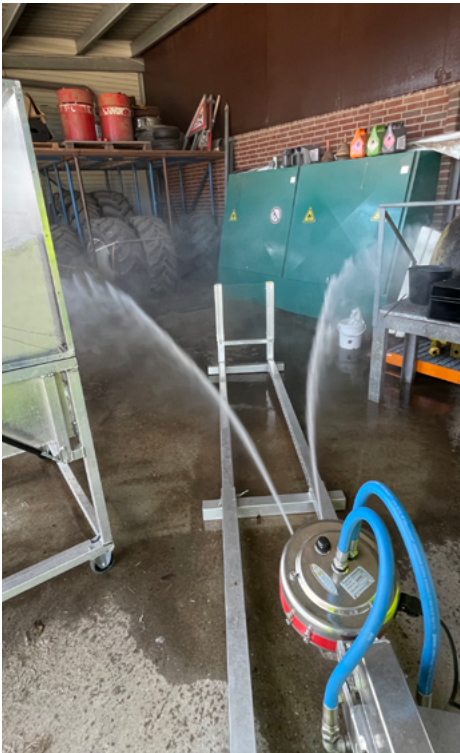
a. Spuitkop van de hogedrukreiniger beweegt waterstraal met een druk van 42 bar automatisch van rechts naar links.
