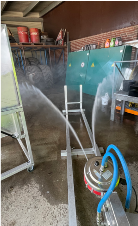
f. Glas 1 reinigen met hogedrukspuit met bewegende waterstraal (vergelijkbaar met praktijk, alleen dan horizontaal ipv verticale waterstraal), opstelling geleverd door Van der Waay.
