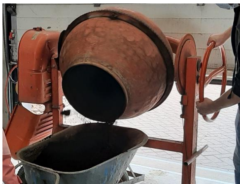
Figuur 3.1 Mengen van de producten door de grond met een betonmolen.
