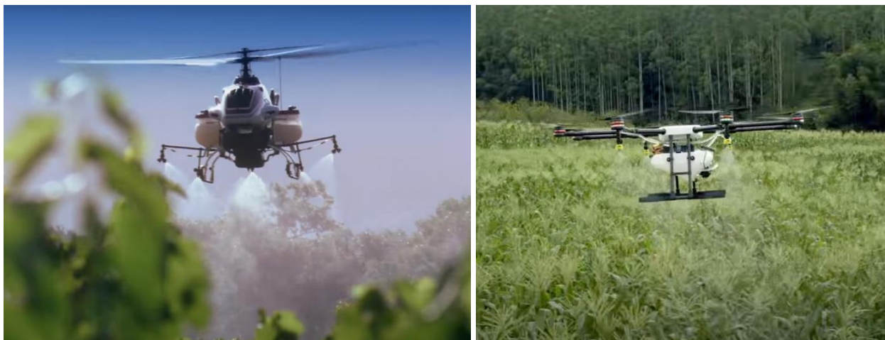
Figuur 4 Links: Yamaha RMAX spuitdrone in actie in een wijngaard in Napa Valley (bron: https://youtu.be/ydfPzqaNkuA ); Rechts de DJI AGRAS MG (bron: https://youtu.be/4gGMMPMm9MQ ).
