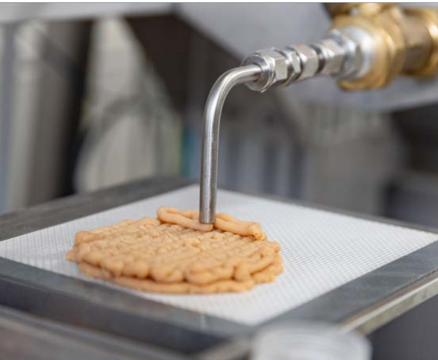
3D-printer PSP print een plantaardige burger, opgebouwd uit meerdere lagen voor een goede bite.
