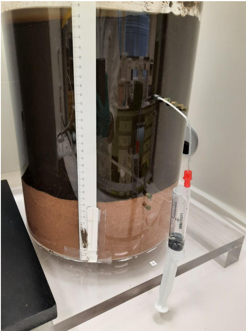
Afbeelding 2. Kolomopstelling met slib uit Loosdrecht. Extractie van poriewater met een rhizon
