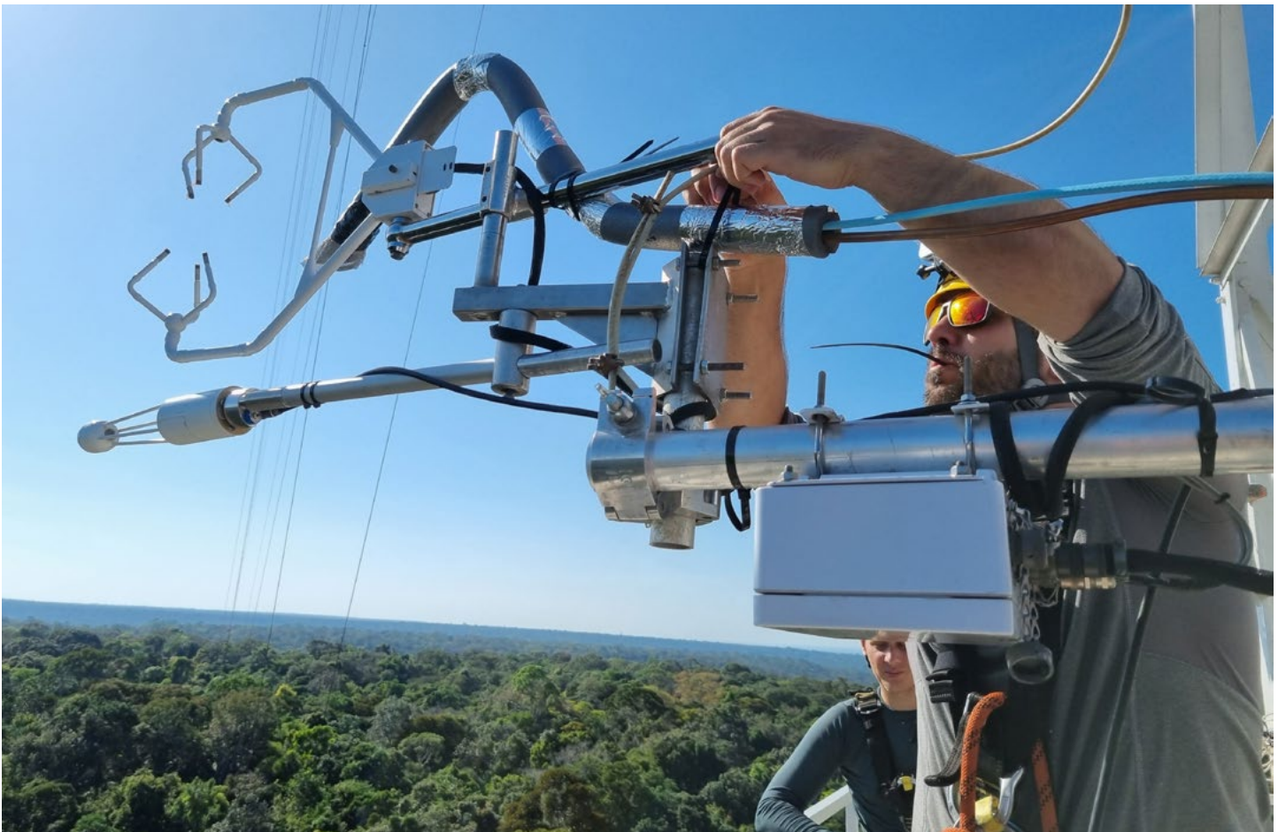
In de meetmast maakt technicus David Bonell Fontas (Universiteit Utrecht) de apparatuur in orde. Met de opstelling kan het transport van CO 2 , H 2 O en hun isotopensamenstelling worden gemeten. • Foto Oscar Hartogensis
