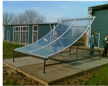
Figuur 5.1. Eerste proefmodel van gehard gebogen glas.
