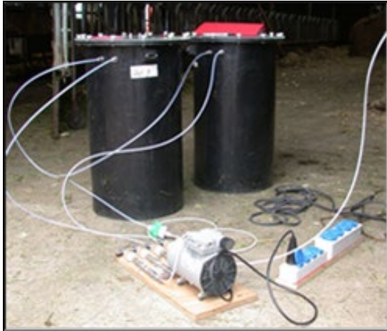
Figuur 2.9 Meetopstelling WLR voor broeikasgas-referentiemetingen (via longmethode). Gesloten vaten met 40 liter Nalophan monsternazakken voor luchtbemonstering, monsternameleiding (teflon of polyethyleen) en kritische openingen (borosilicaatglas (binnendiameter: 8 mm; lengte: 80 mm), ondergebracht in een roestvrijstalen container voor bescherming; flow: ~ 20 ml/min). Lucht wordt met behulp van een pomp (Thomas Industries Inc., model 617CD32, Wabasha, Minnesota, VS) uit het vat gezogen, waardoor de lucht in de zakken wordt aangezogen.
