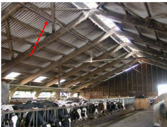
Figuur 2.2 Meetopstelling met monsternameleiding. Links: voorbeeld monsternameleiding in de stal. Rechts: voorbeeld van monsternamepunt met kritische opening en stoffilter.
