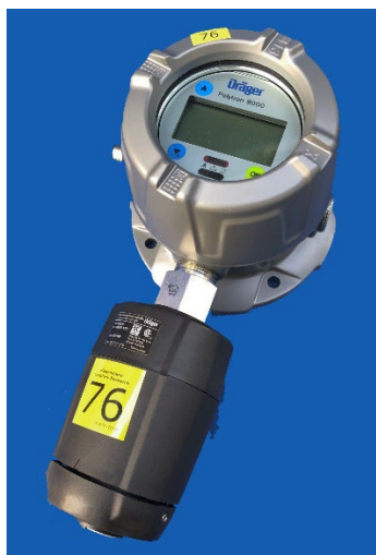
Figuur B2.1 Dräger Polytron 8000 met de FL-6813260 sensor voor \text{NH}_3 -concentratiemetingen.
