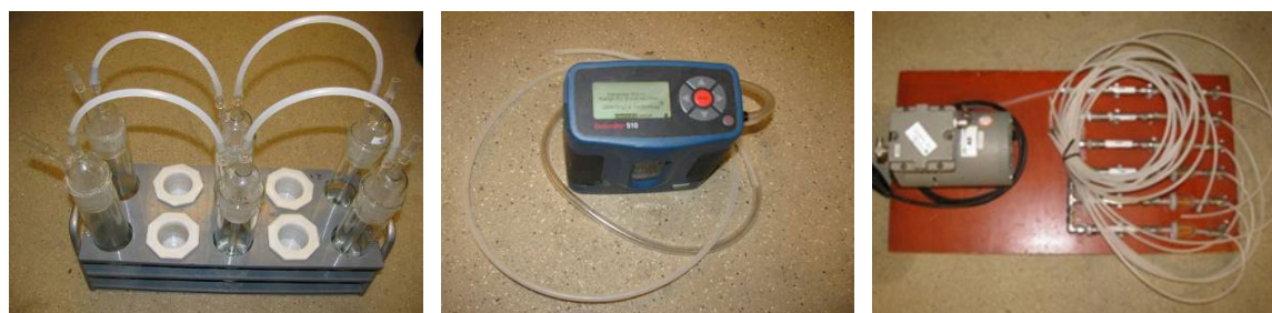
Figuur 2.8 Meetopstelling WLR voor NH 3 -referentiemetingen. Links: wasflessen. Midden: Droge gasstroommeter (DryCal® Defender 510-m, Bios Int. Corp, VS). Rechts: pomp (Thomas Industries Inc., model 617CD32, Wabasha, Minnesota, VS), monsternaleiding (teflon of polyethyleen) en kritische openingen (borosilicaatglas (diameter: 8 mm; lengte: 80 mm), gehuisvest in a roestvrijstaal container voor bescherming).
