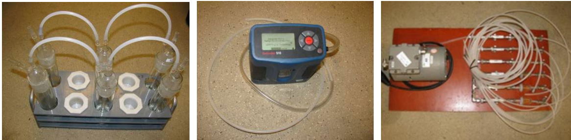
Figuur B2.6 Meetopstelling WLR voor \text{NH}_3 -referentiemetingen. Links: wasflessen. Midden: Droge gasstroommeter (DryCal® Defender 510-m, Bios Int. Corp, VS). Rechts: pomp (Thomas Industries Inc., model 617CD32, Wabasha, Minnesota, VS), monsternameleiding (teflon of polyethyleen) en kritische openingen (borosilicaatglas (diameter: 8 mm; lengte: 80 mm), gehuisvest in a roestvrijstaal container voor bescherming).
