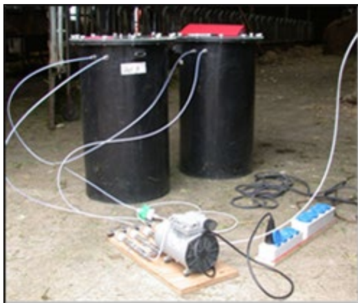
Figuur B2.6 Meetopstelling WLR voor broeikasgas-referentiemetingen (via longmethode). Gesloten vaten met 40 liter Nalophan monsternazakken voor lucht bemonstering, monsternameleiding (teflon of polyethyleen) en kritische openingen (borosilicaatglas (binnendiameter: 8 mm; lengte: 80 mm), ondergebracht in een roestvrijstaal container voor bescherming; flow: ~ 20 ml/min). Lucht wordt met behulp van een pomp (Thomas Industries Inc., model 617CD32, Wabasha, Minnesota, VS) uit het vat gezogen, waardoor de lucht in de zakken wordt aangezogen.
