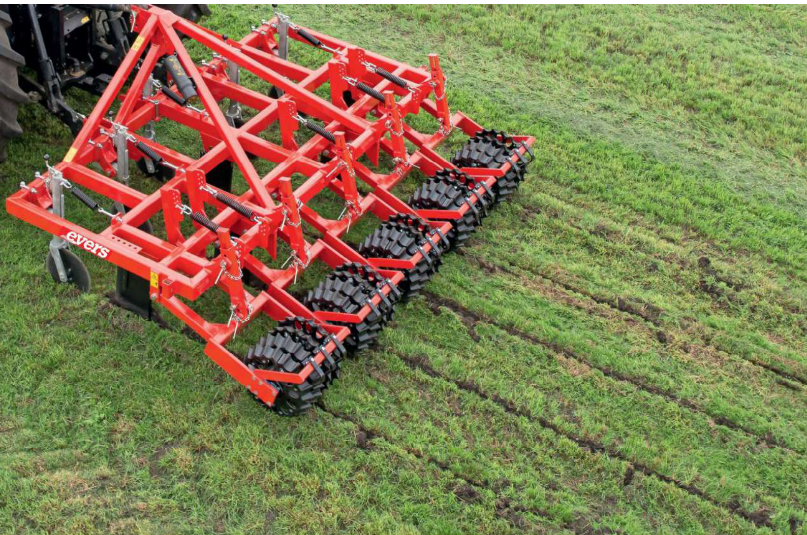
Een graslandwoeler maakt een verdichte bodem los zonder de zode te vernieuwen. Een schijf snijdt de zode open, een woeltand werkt de storende laag los, en een nalooprol drukt alles aan. De Evers-graslandwoeler is ook op de Grasdag 2022 te zien.
