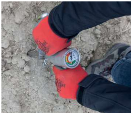
Met een penetrometer is de bodem te controleren op storende lagen. Dit kun je het beste bij een vochtige bodem in het voorjaar doen. Bijvoorbeeld in februari.
