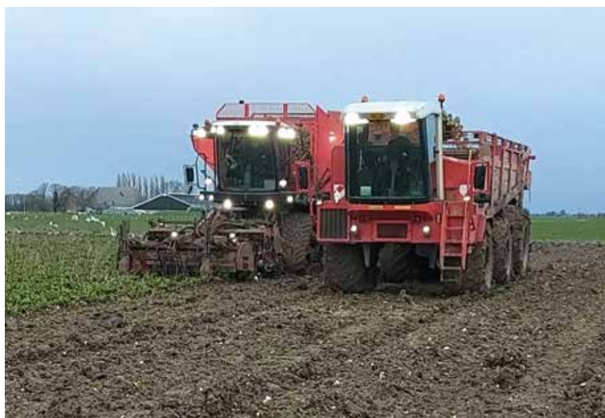
De Agrifac LightTraxx op rupsen met de Gilles-uitrijwagen, waarmee Drijfhout goed scoort. Drijfhout heeft het rupsonderstel voorzien van open sprocketwielen, omdat dat beter werkt op de klei.
