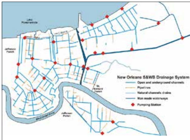
Drainagesysteem van New Orleans met vele pompstations (rood)
