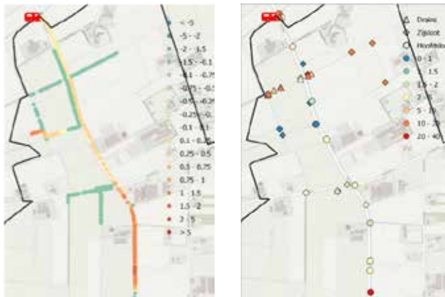
Afbeelding 1. Resultaten routings februari 2022. Links de temperatuur (verschil met referentie (°C)) en rechts nitraatconcentraties. Dit geeft een beeld van waar relatief veel kwel wordt afgevoerd (links, oranje gekleurde sloten en beekloop) en zones waar veel nitraat uitspoelt (rechts).
