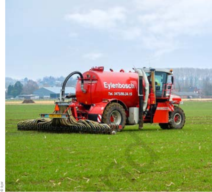
Het injecteren van mengmest met een schijfkouter.
