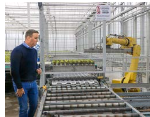
Teler Nico Goossens bij de robot die tot 10.000 jonge plantjes per uur kan planten en ze op het gotensysteem zet.
