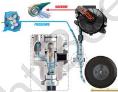
Figuur 2. Het individuele zaadje wordt enerzijds naar beneden gezogen en anderzijds naar beneden geblazen. Dit gebeurt door de lobben-blower die een Venturi-element in elke zaaipijp activeert.
