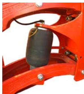
Figuur 3. Snel rijden betekent ook dat de zaaishijven goed in de grond op de juiste diepte moeten blijven. Maschio bouwt hiervoor een luchtdrukbalg in met regelbare druk.
