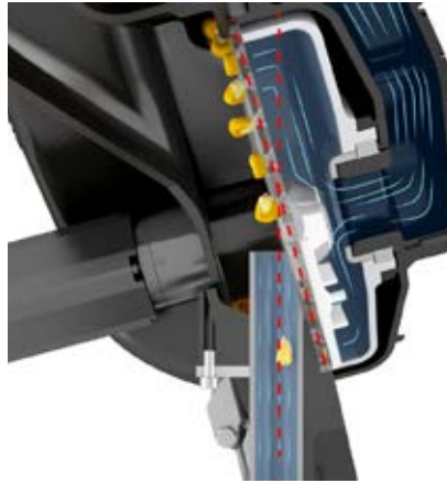
Figuur 1. Maschio Gaspardo blijft bij het principe van zaadverenkeling via vacuüm. Om de valbeweging te versnellen wordt het zaaielement onder een hoek geplaatst.
