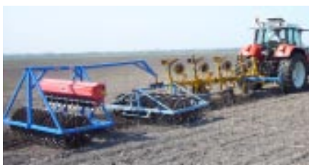
Foto 4. Ploegen met vorenpakker.*
