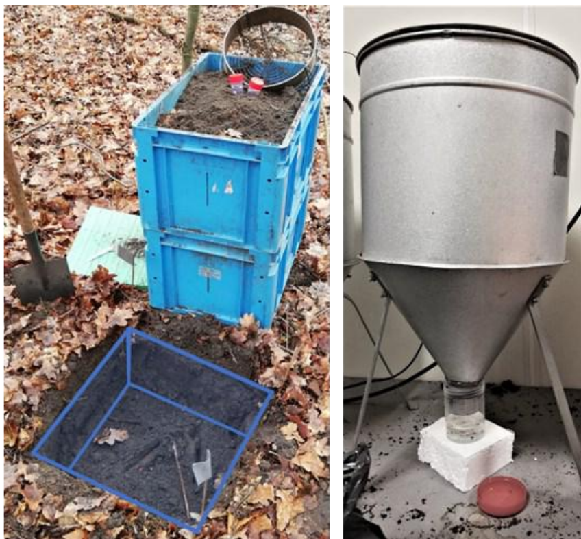
Figuur 4.25. De toplaag, bestaande uit de bovenste 5 cm van de ectorganische laag en minerale bodem, is bemonsterd met behulp van een springvorm en meegenomen naar het laboratorium voor extractie in een tullgren-trechter (rechts), waarna de macrofauna uit de daaronder liggende lagen over een oppervlakte van 50x50 cm tot een diepte van maximaal 25 cm op locatie is gesorteerd met behulp van een zeef boven een bak.
