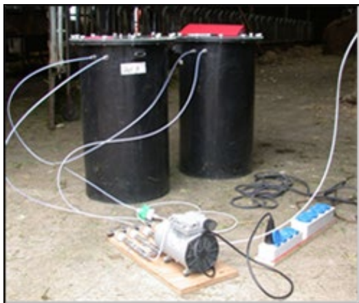
Figuur B2.5 Meetopstelling WLR voor broeikasgas-referentiemetingen (via longmethode). Gesloten vaten met 40 liter Nalophan monsternazakken voor luchtbemonstering, monsternameleiding (teflon of polyethyleen) en kritische openingen (borosilicaatglas (binnendiameter: 8 mm; lengte: 80 mm), ondergebracht in een roestvrijstalen container voor bescherming; flow: ~ 20 ml/min). Lucht wordt met behulp van een pomp (Thomas Industries Inc., model 617CD32, Wabasha, Minnesota, VS) uit het vat gezogen, waardoor de lucht in de zakken wordt aangezogen.
