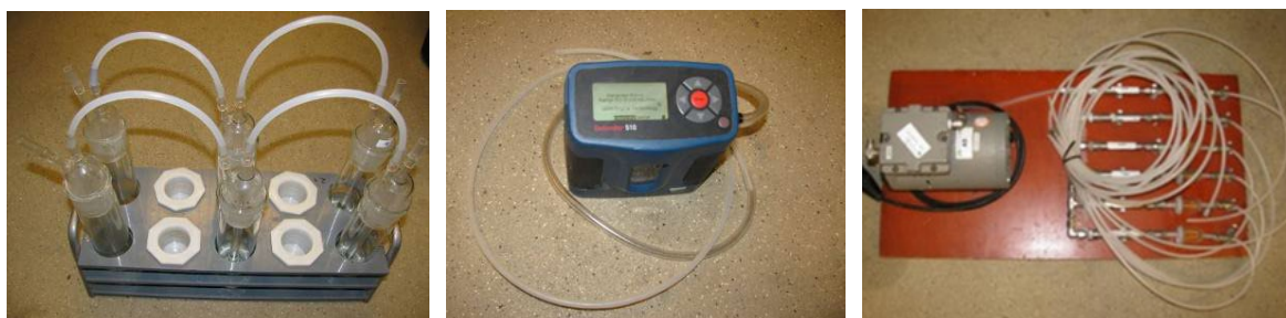
Figuur B2.4 Meetopstelling WLR voor NH 3 -referentiemetingen. Links: wasflessen. Midden: Droge gasstroommeter (DryCal® Defender 510-m, Bios Int. Corp, VS). Rechts: pomp (Thomas Industries Inc., model 607CD32, Wabasha, Minnesota, VS), monsternameleiding (teflon of polyethyleen) en kritische openingen (borosilicaatglas (diameter: 8 mm; lengte: 80 mm), gehuisvest in a roestvrijstaal container voor bescherming).
