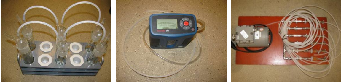
Figuur 2.5 Meetopstelling WLR voor \text{NH}_3 -referentiemetingen. Links: wasflessen. Midden: Droge gasstroommeter (DryCal® Defender 510-m, Bios Int. Corp, VS). Rechts: pomp (Thomas Industries Inc., model 617CD32, Wabasha, Minnesota, VS), monsternameleiding (teflon of polyethyleen) en kritische openingen (borosilicaatglas (diameter: 8 mm; lengte: 80 mm), gehuisvest in a roestvrijstaal container voor bescherming).
