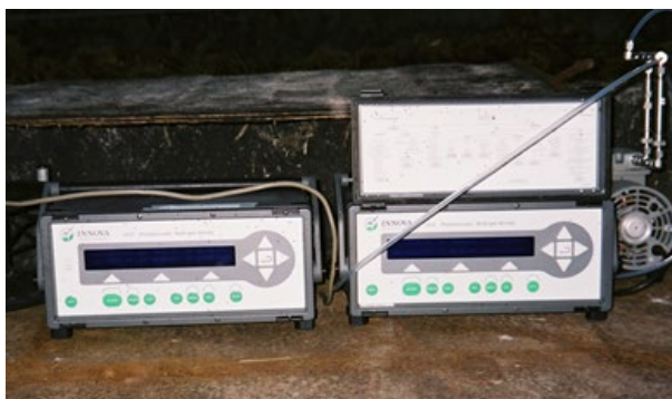
Figuur B2.7 Innova 1312 voor het meten van de CO 2 -concentraties bij de boxmetingen.
