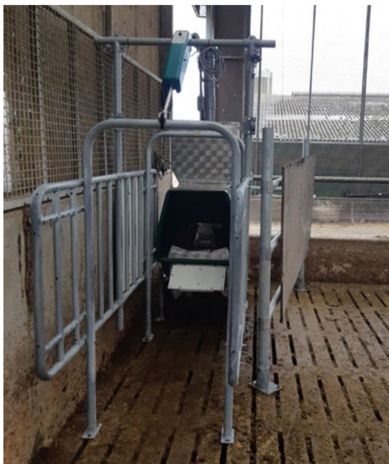
Figuur 1. De GreenFeed box, die enterische methaanemissie meet, is onmisbaar voor dergelijk praktijkonderzoek.
