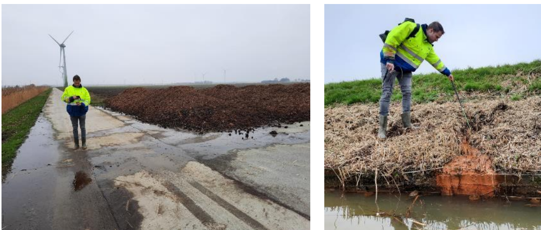
Figuur B2.11 Uitspoelend water vanuit een hoop vaste stalmest met hoge nitraatconcentratie (links) en een drain die direct op de tocht uitkomt en gezien de ijzeroxideneerslag ijzerrijk kwelwater lijkt af te voeren (rechts).
