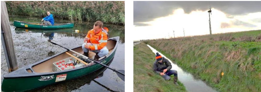
Figuur B2.2 Routing in de Vuursteentocht vanuit kano's (links); op de voorgrond de kano van waaruit reguliere monsters genomen worden, op de achtergrond de kano met drijver voor de EC GPS-Rod. Rechts: bemonstering van water in een kavelsloot en een drain.
