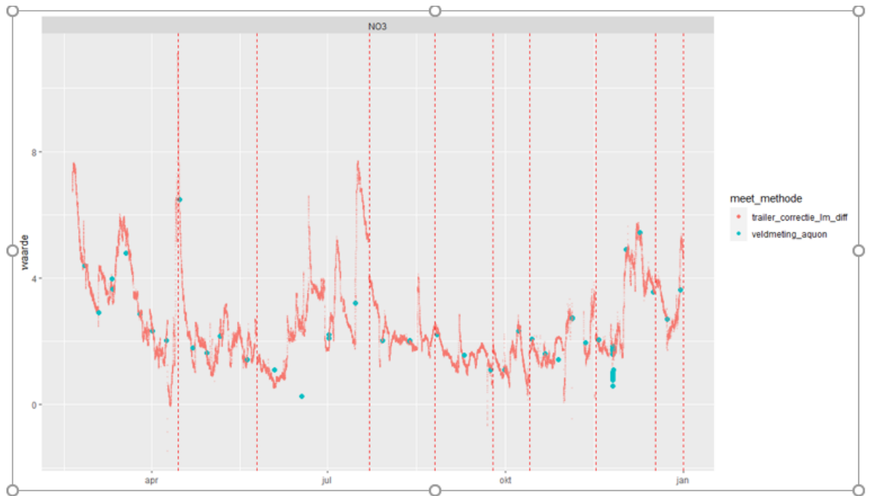
Figuur B4.5 De volledige meetreeks voor nitraat na correctie op laboratoriummetingen voor de Vinkenloop.
